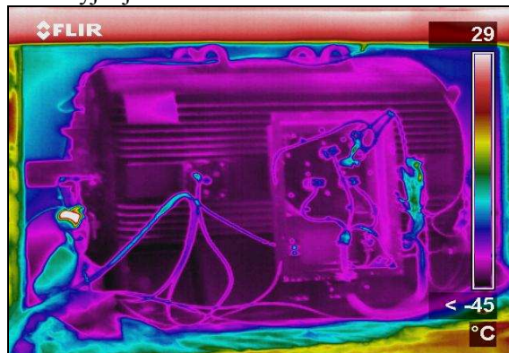
Fot. 6. Rozkład temperatur silnika bezpośrednio po otwarciu komory badawczej
