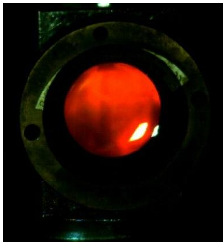
b) płomień wypenający wnętrze komory iskiernika
