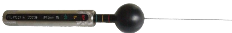
Rys. 5 – Próbnik dostępu – drut o średnicy 1mm, wykorzystywana do sprawdzania stopnia ochrony przed dostępem do części niebezpiecznych – pierwsza cyfra charakterystyczna – 4, 5, 6 oraz przed wnikaniem obcych ciał stałych – pierwsza cyfra charakterystyczna – 4.
